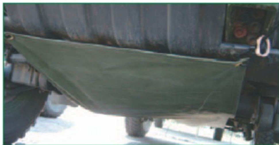
La CPEV est accrochée directement sous le véhicule.
