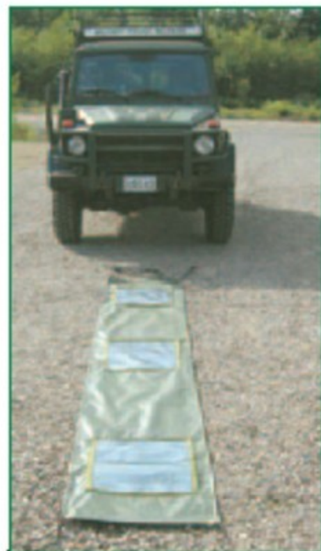
La couche de protection environnementale de véhicule (CPEV) pour le Mercedes G-Wagon.
